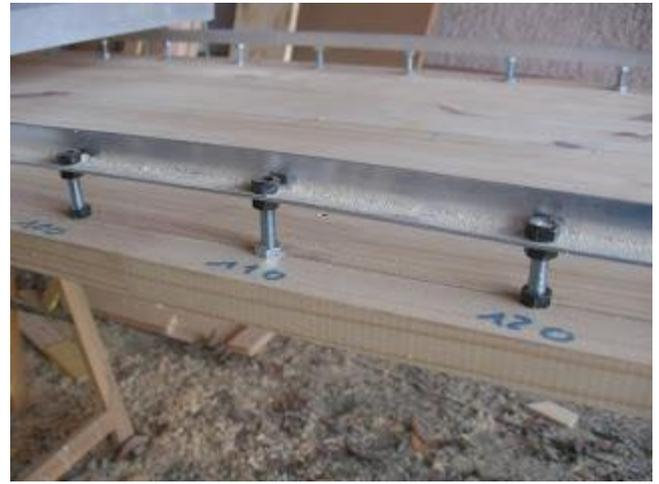
Attention : bien vérifier la planéité de la planche avant mise en œuvre sinon impossible de réaliser des faibles épaisseur
