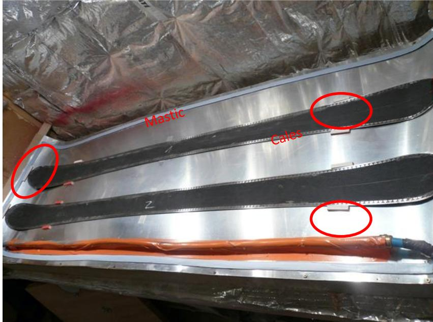
*Ici la table est préformée et recouverte d'une tôle sur laquelle est collée la bâche avec le mastic. Lors de la formation du vide, le sandwich est plaqué contre la tôle – pas d'utilisation de tasseau de déformation*
